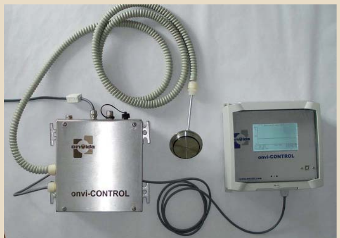
Abb. 1 Messsystem mit Biofilmsensor zur Online-Biofilmüberwachung
